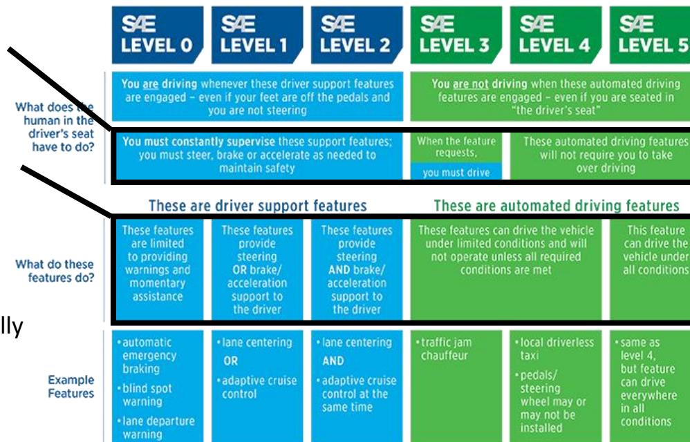
Society of Automotive Engineers Stufen der Fahrautomatisierung [2]
