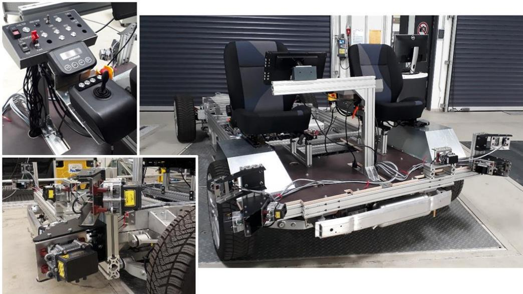
**Abbildung 7: Versuchsträger PLUTO mit Unterkonstruktion und Laserscannern.**
