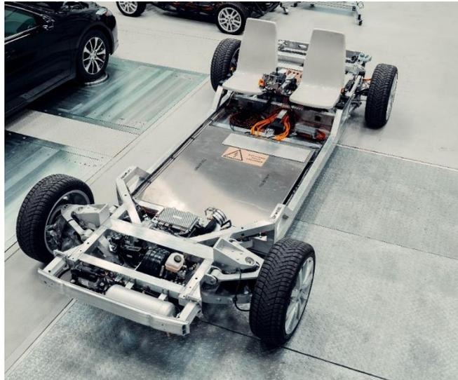
**Abbildung 5: HFM Motionboard im Anlieferungszustand.**
