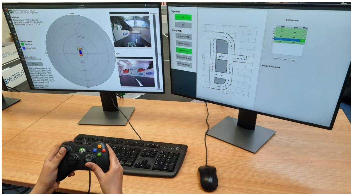
Abbildung 39: Fernsteuerung des autonomen Fahrzeugs im Leitstand-GUI V1.0.
